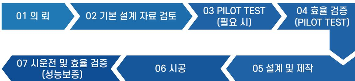
• PILOT TEST 및 MONITORING SYSTEM을 통해 검증된 방지시설 제작 및 설치
